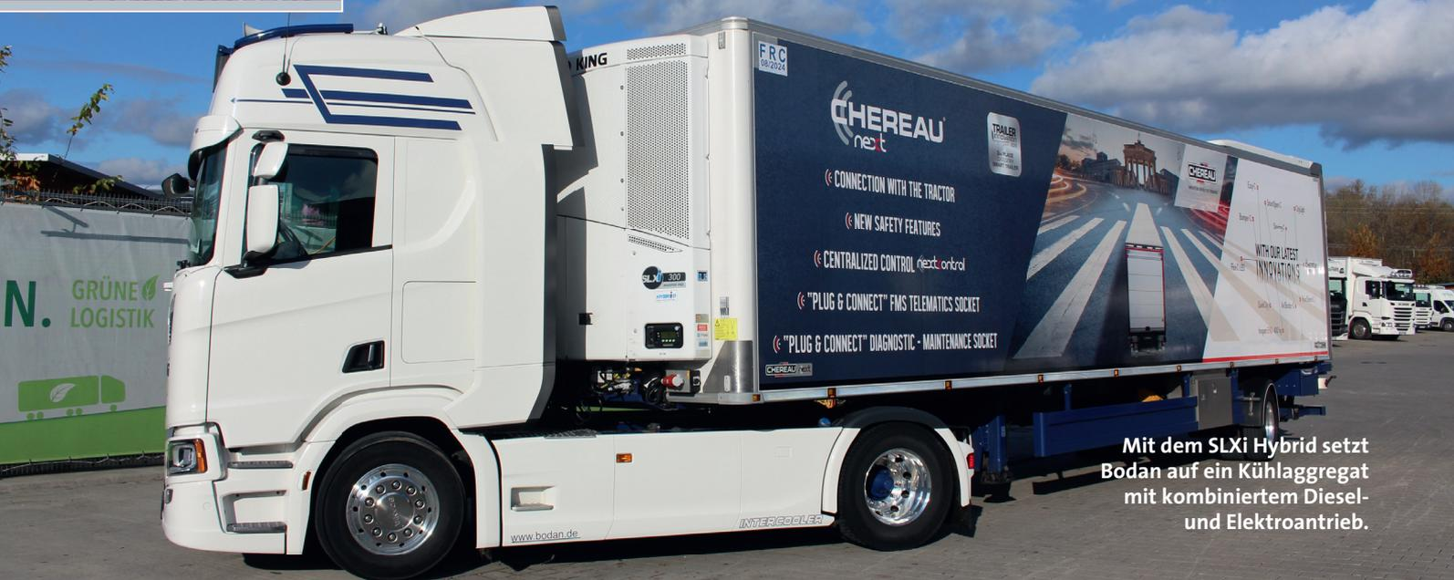
Mit dem SLXi Hybrid setzt Bodan auf ein Kühlaggregat mit kombiniertem Diesel- und Elektroantrieb.
